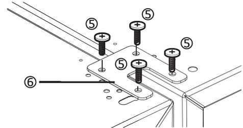
6. Enlevez la vis n° (5) au bas de l'avant du produit. Alignez le cadre de support n° (2) avec le trou du produit et fixez-le de nouveau à l'aide de la vis n° (5).
