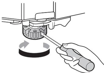
3. Si la porte de l'appareil n'est pas de niveau, ajustez la différence de hauteur de la porte de l'appareil.
