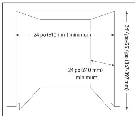
Ce lave-vaisselle est conçu pour être encastré sur le dessus et sur les deux côtés dans une unité de cuisine résidentielle standard. L'espace d'installation doit être propre et exempt d'obstructions. L'espace doit être d'au moins 24 pouces de largeur, 24 pouces de profondeur et 34 1/8 pouces de hauteur. Pour que la porte avant du lave-vaisselle soit à égalité avec le bord supérieur du dessus du comptoir, le dessus du comptoir doit avoir une profondeur d'au moins 25 pouces.
